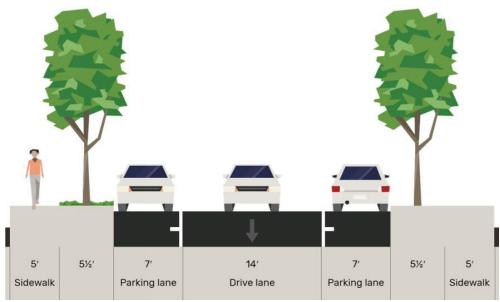
FIGURE 9: LOCAL STANDARD CROSS-SECTION
